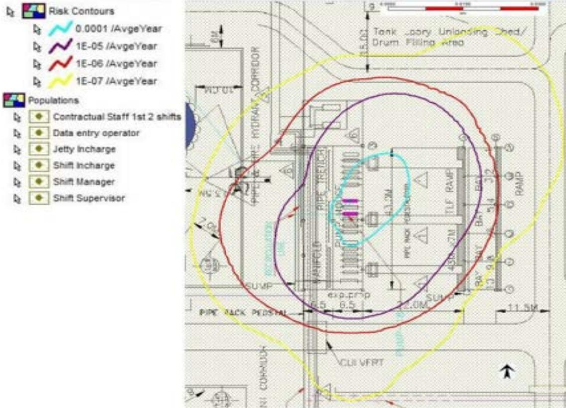
FIGURE 27: LSIR CONTOUR : FAILURE - PUMP P-08
