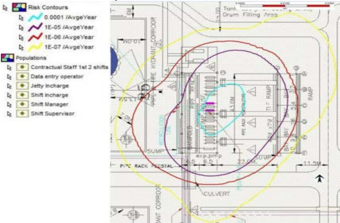
FIGURE 28: LSIR CONTOUR : FAILURE - PUMP P-18
